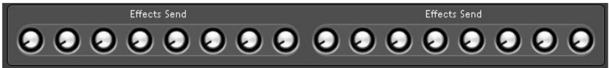
Поворот регулятора Send по часовой стрелке увеличивает количество сигнала, который подается на цифровой процессор эффектов; поворот против часовой стрелки уменьшает количество сигнала, посылаемого на процессор.
